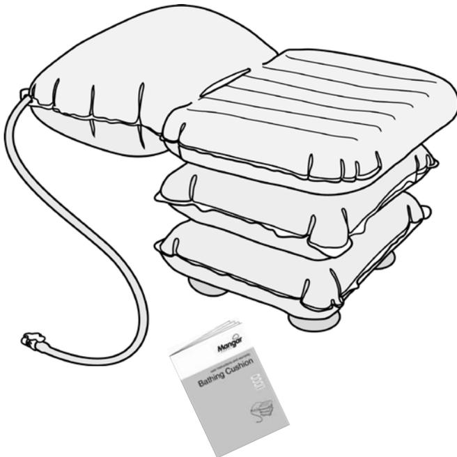
**OPMERKING:** De zuigdooppen bevatten 1 atex. De zuigdooppen bevinden zich aan de onderkant van de zitting en staan normaal gesproken niet in direct contact met de gebruiker tijdens het gebruik.
